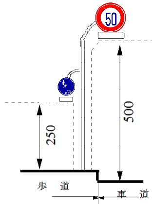
図例(4) 信号機、電柱その他工作物を利用する方式
