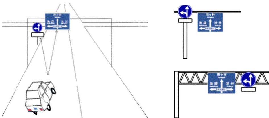
図例(2) 進路変更禁止又は進行方向別通行区分の規制に対する調整例
