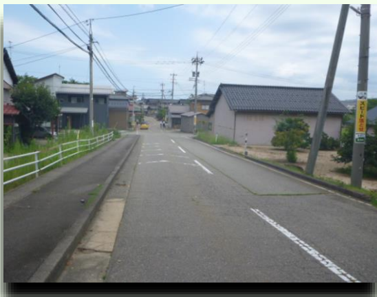
車道幅員の縮小(能美市宮竹町・ゾーン30プラスの事例)
